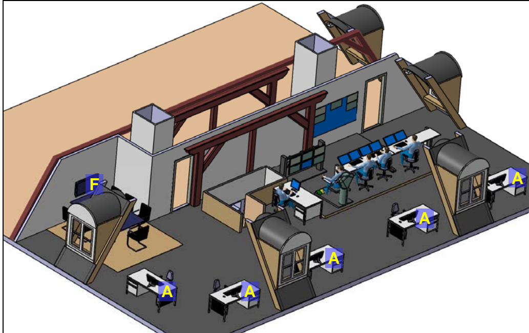
Figuur 2 - Control room layout
